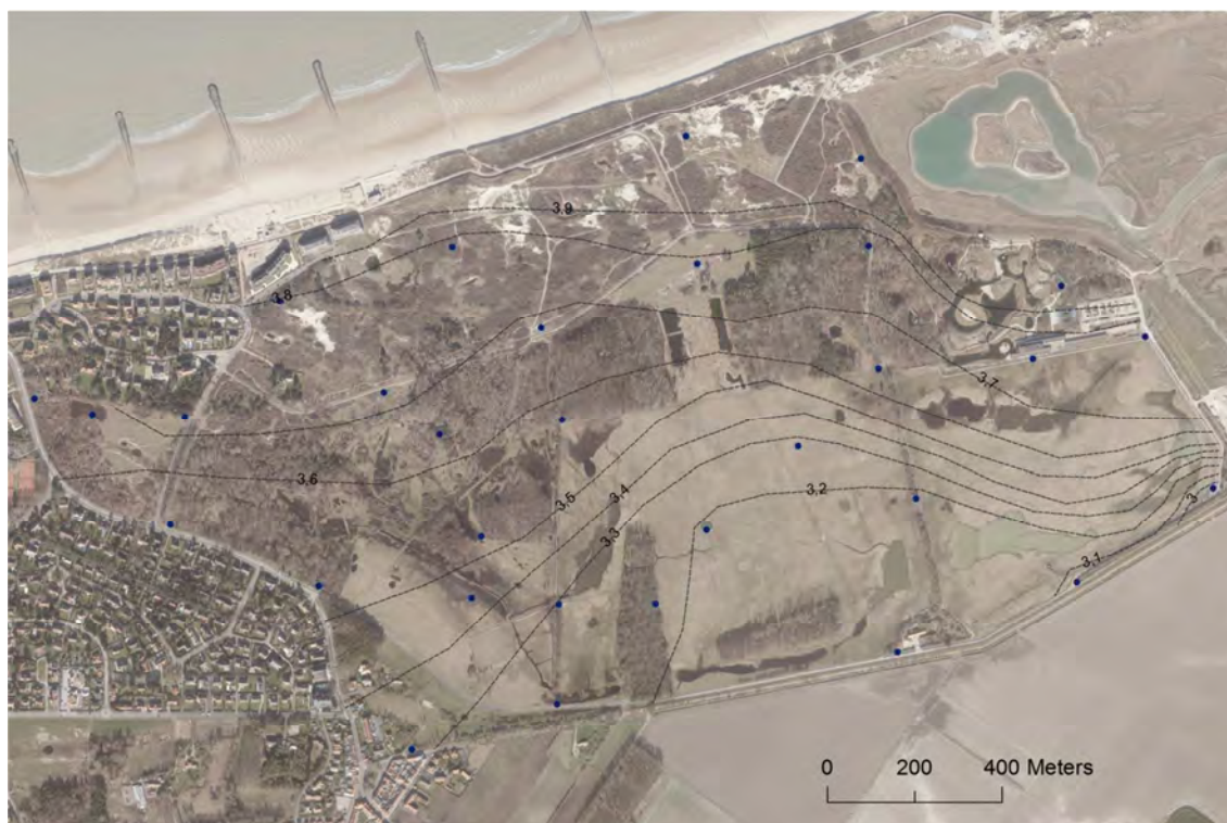
Figuur 3.108. Lijnen van gelijke stijghoogte van de gemiddelde minimale grondwaterstanden in De Zwinduinen voor de jaren 2014-2018.
