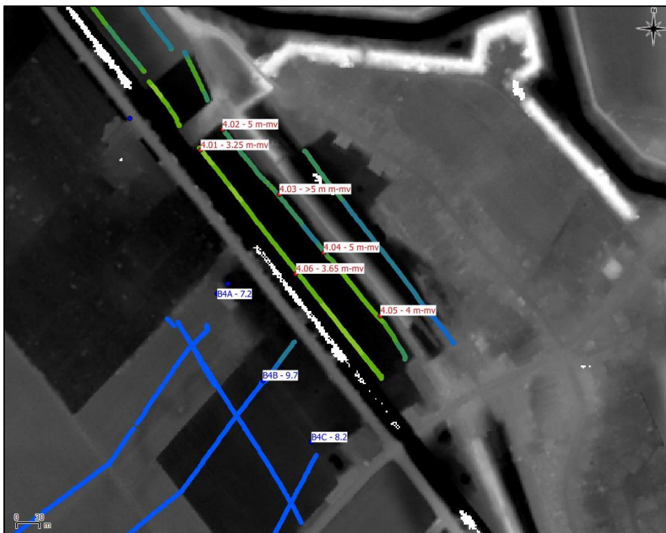
Figuur 51: locatie EC-sonderingen en peilbuizen grondwatermeetnet (label = ID EC-sondering/peilbuis en diepte zoet-zout overgang) samen met EC-waarden EM31-meting (verticaal) op de hoogtekartaart (3/4).
