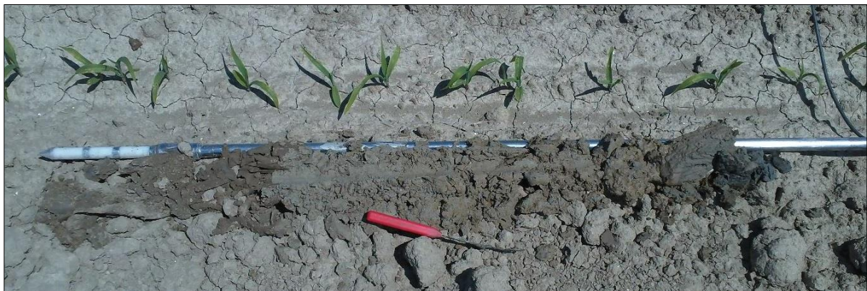
Figuur 24: boorprofiel op meetlocatie P3. De prikstok dient als dieptereferentie.
