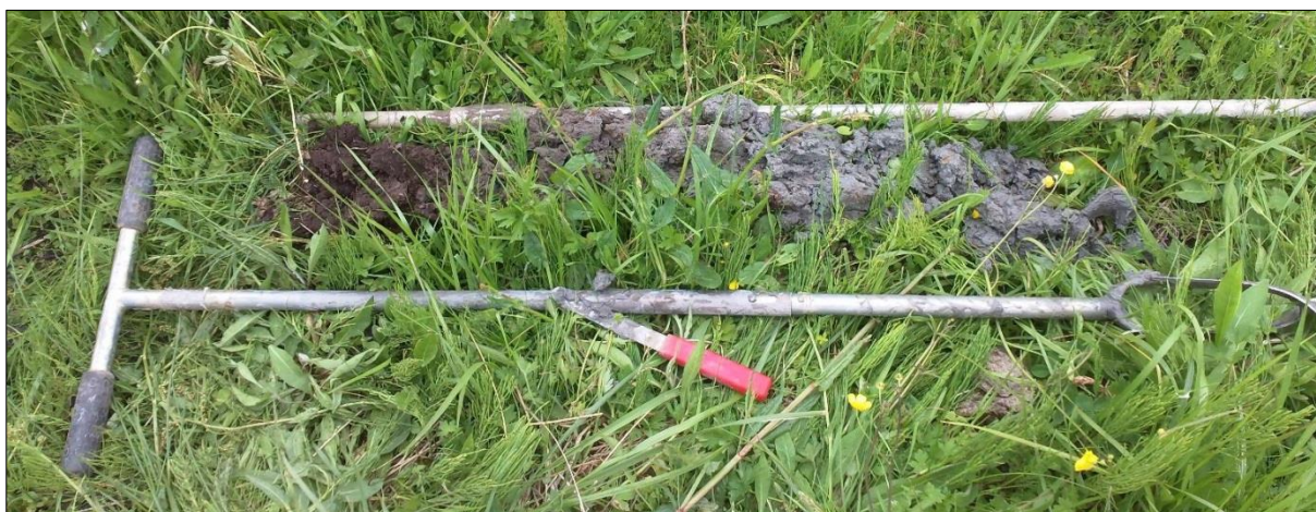
Figuur 30: boorprofiel op meetlocatie P7. De prikstok dient als dieptereferentie.
