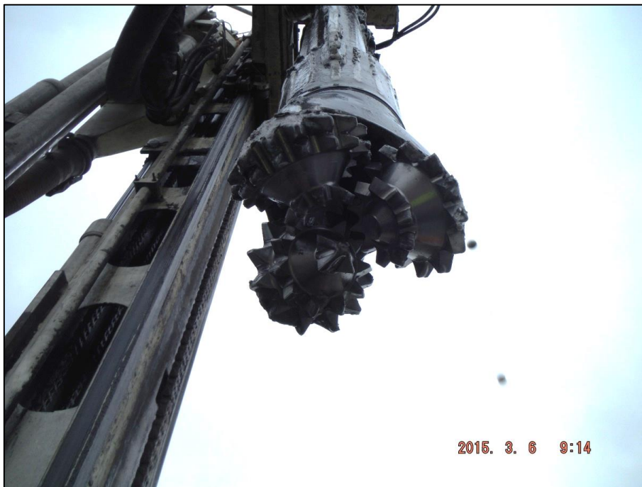
Figuur 33: Boorkop met rolbeitel (180 mm).
