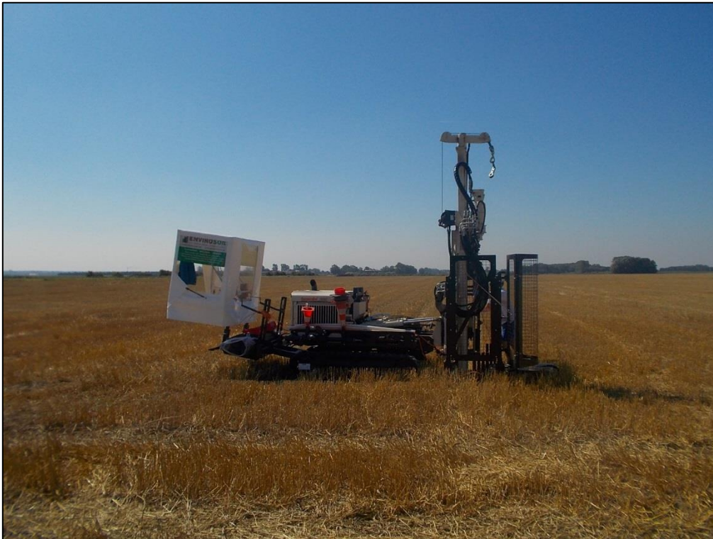
Figuur 47: Geoprobe tijdens de uitvoering van de veldmetingen aan het Zwin.
