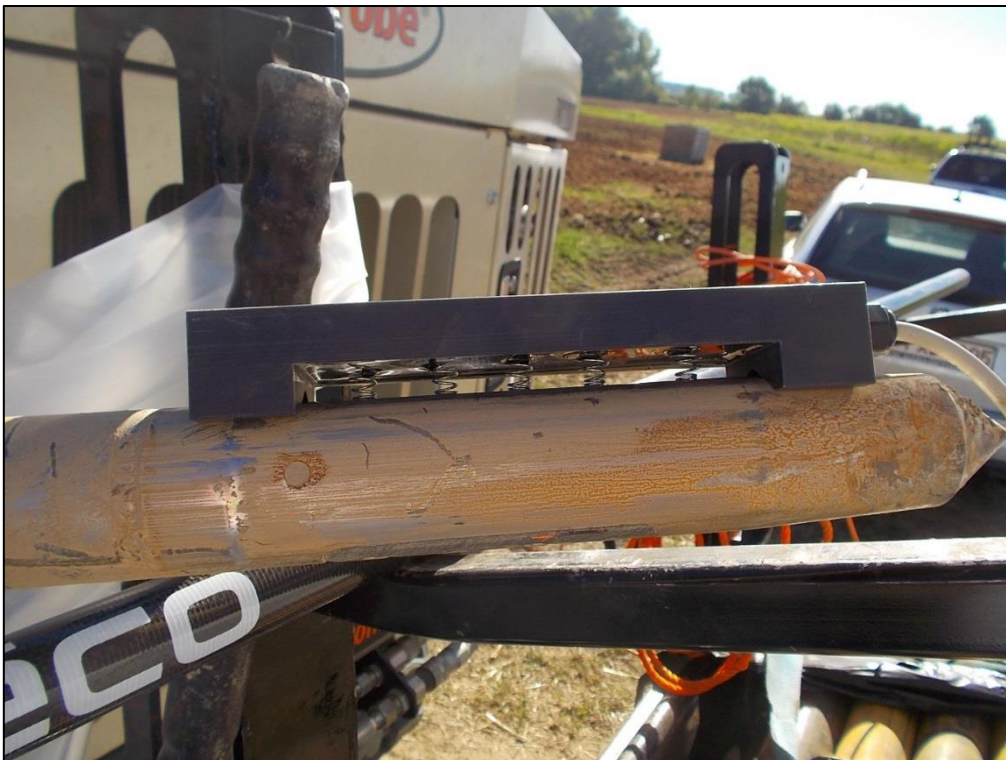
Figuur 48: SC500 EC Probe.
