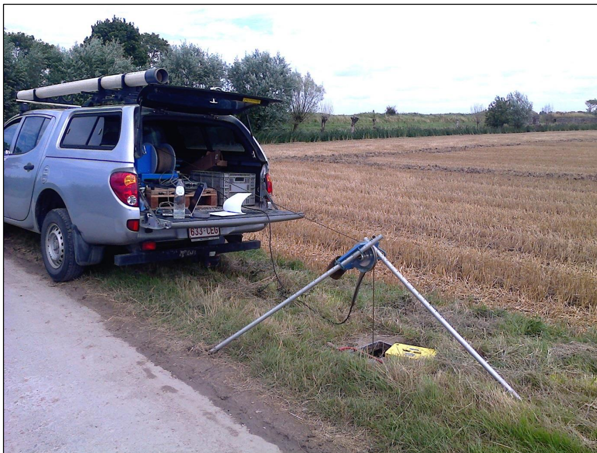
Figuur 58: opstelling EM-meting in een peilbuis.
