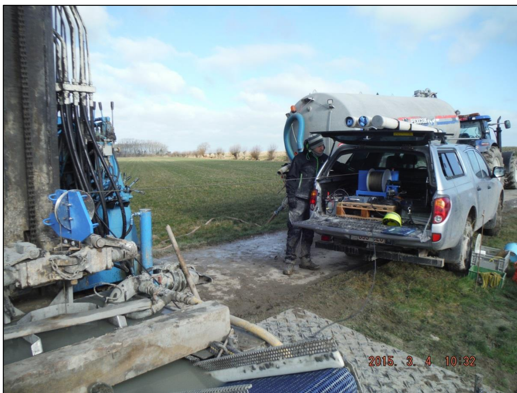
Figuur 35: Meetopstelling van de geofysische boorgatmetingen.
