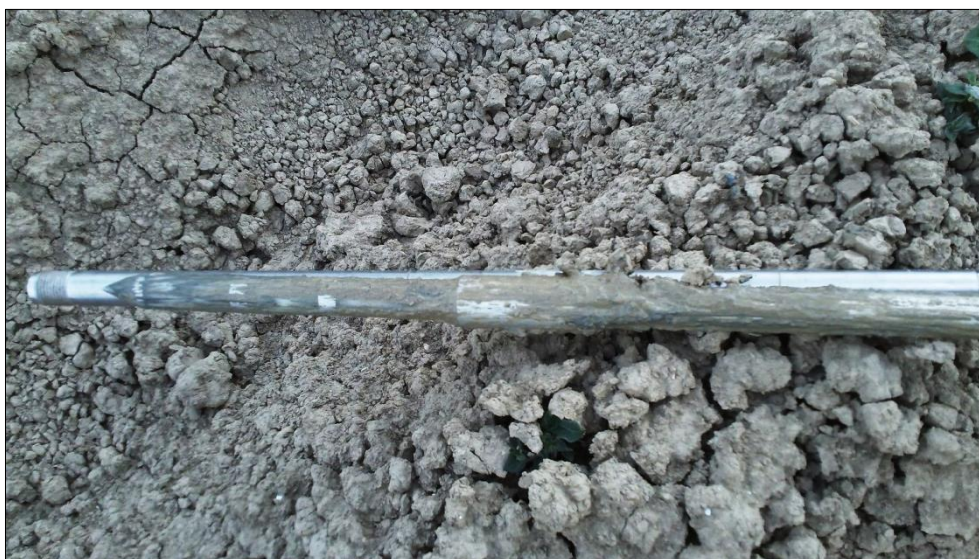
Figuur 27: restgrond aan de tip van de prikstok na het uithalen.
