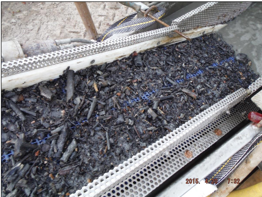
Figuur 37 Boring 4A: licht gehumificeerde, doch intacte houtresten tussen 6,5 en 7,5 m-mv.
