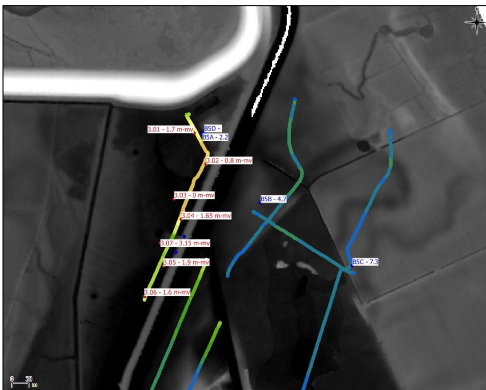
Figuur 52: locatie EC-sonderingen en peilbuizen grondwatermeetnet (label = ID EC-sondering/peilbuis en diepte zoet-zout overgang) samen met EC-waarden EM31-meting (verticaal) op topografische kaart (4/4).
