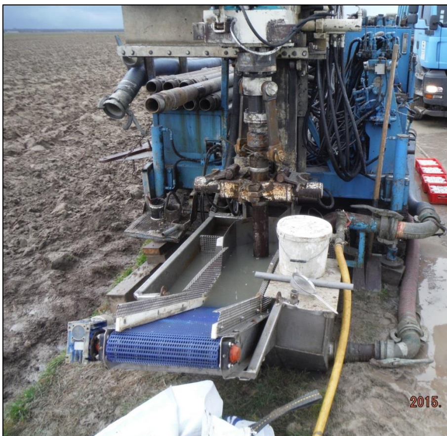
Figuur 34: voorkant boorinstallatie: spoelbak met grove zeef voor afscheiding grove fractie (klei- en veenbrokken, schelpen).
