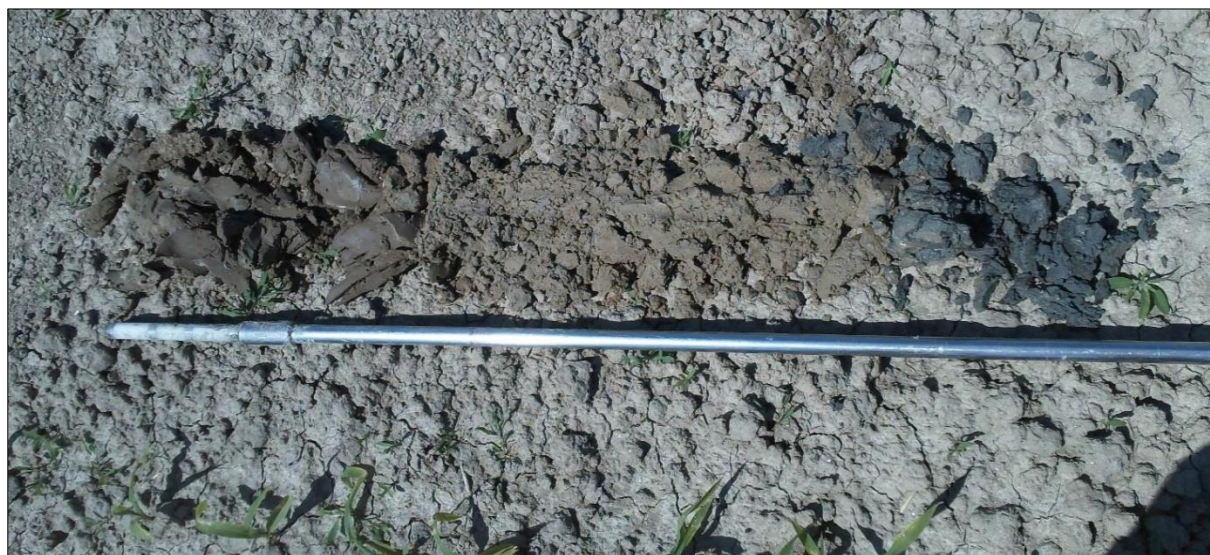
Figuur 23: boorprofiel op meetlocatie P2. De prikstok dient als dieptereferentie.
