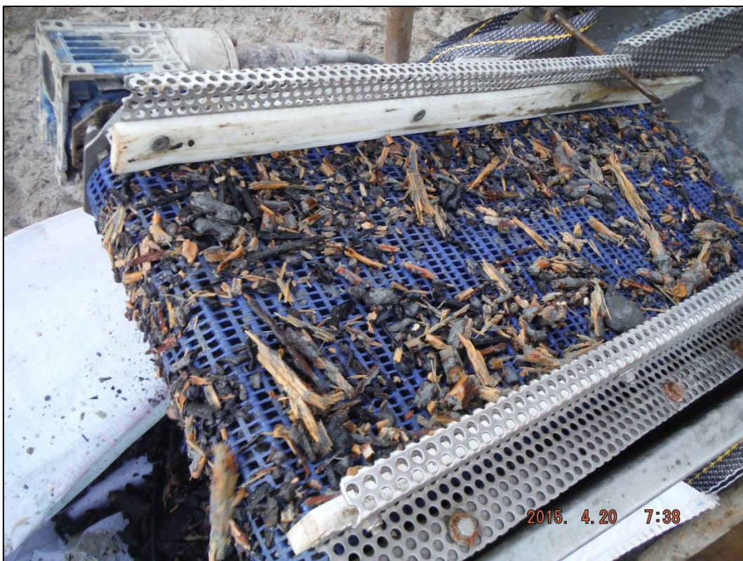
Figuur 37 Boring 4A: licht gehumificeerde, doch intacte houtresten tussen 6,5 en 7,5 m-mv.
