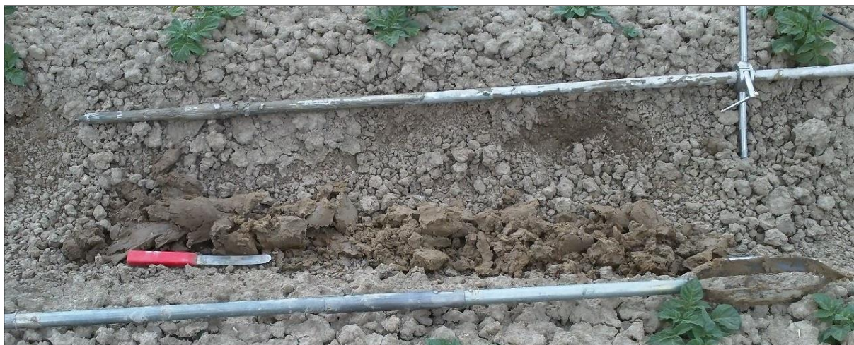
Figuur 29: boorprofiel op meetlocatie P6. De prikstok dient als dieptereferentie.
