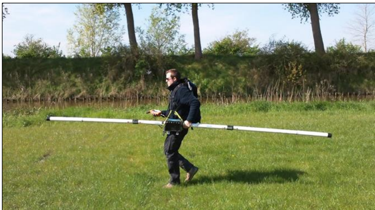
Figuur 5: Meting met een EM31-MK2 toestel op 17/04/2014 aan het Zwin.
