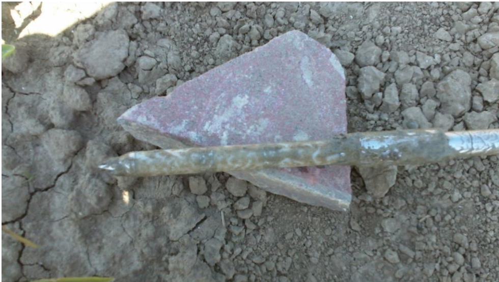
Figuur 22: restgrond dat aan de tip van de sonde overblijft na uithalen van de sonde.
