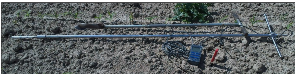
Figuur 19: TEC-sonde en EC-meter. Daarnaast een Edelman-boor en spatel gebruikt voor het voorboren.
