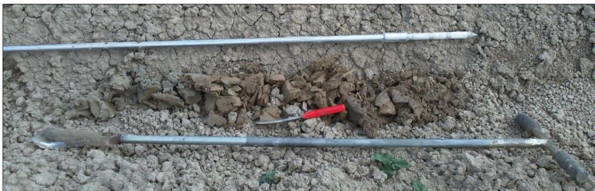
Figuur 26: boorprofiel op meetlocatie P5. De prikstok dient als dieptereferentie.
