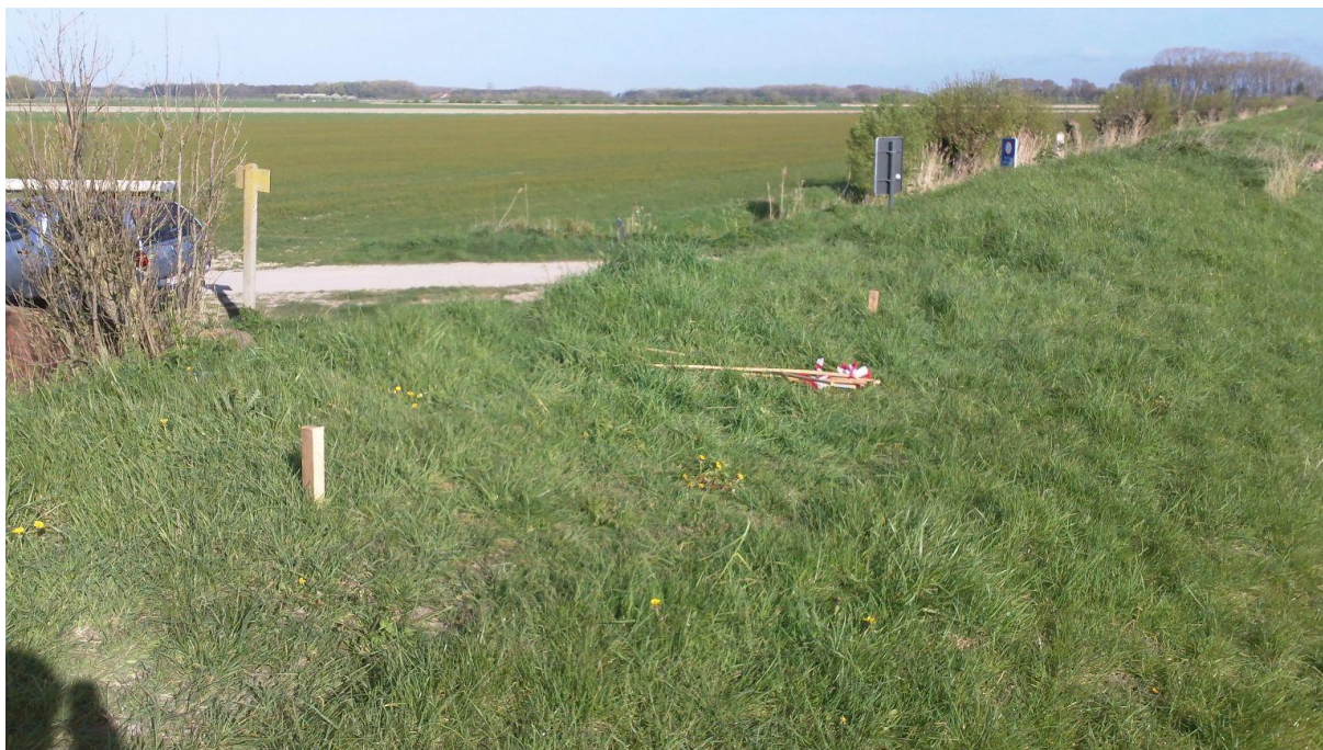
Figuur 7: aanduiding van de kalibratiepositie door paaltjes aan weerszijden van de sensor.
